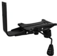
Syncro Reclinable 1. Ajuste de altura 2. Reclinación sincronizada 3:1 de respaldo y asiento con bloqueo en posición inicial. 3. Perilla para ajustar la suavidad de la reclinación.
