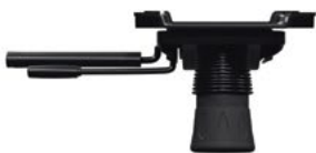
Mecanismo SYNCRO Con Silde 1. Ajuste de altura. 2. Reclinación sincronizada 3:1 de respaldo y asiento con bloqueo en diferentes posiciones. 3. Ajuste de la profundidad del asiento. 4. Perilla para ajustar la suavidad de la reclinación. 5. Sistema Antishock para que el respaldo no regrese de golpe.
