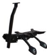
Multifuncional de 2 Palancas 1. Ajuste de altura. 2. Reclinación del respaldo con bloqueo en cualquier ángulo. 3. Perilla para ajustar la altura del respaldo.
